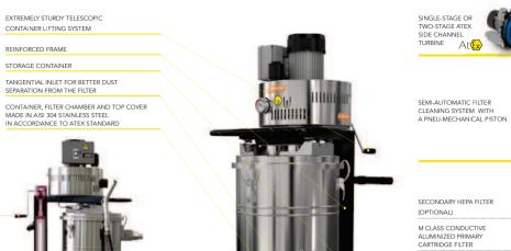
CYCLONE FOR INCRESED FILTER EFFICIENCY
