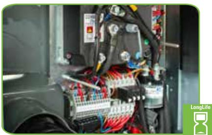
Die ACX-Steuerung ermöglicht die Vernetzung verschiedener Funktionen und steuert so optimal Betriebszustände wie z. B. den Sanftanlauf von Bürsten- und Saugmotoren, die GWS-Steuerung sowie programmierbare Parameter wie Bremsverhalten oder Geschwindigkeit.
