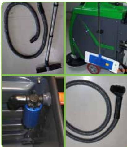
Wartungsfreundlicher und kompletter Zugang zu allen mechanischen und elektrischen Maschinenteilen.
