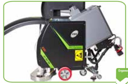
Der kippbare Tank ermöglicht den leichten und schnellen Zugang zu den wichtigsten Bauteilen der Maschine. Das Ausspülen und Reinigen des Tanks wird erheblich erleichtert.
