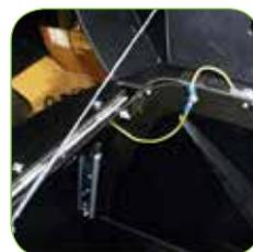
Alle beweglichen Maschinenteile sind mit Erdungskabel mit dem Maschinenkorpus verbunden.
