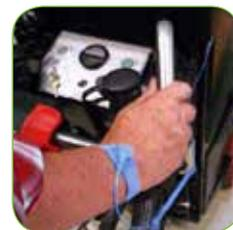
Der Lenkgriff ist aus Edelstahl gefertigt und mit einer Handgelenkskennung für den Maschinenbediener ausgestattet.
