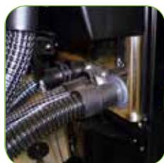
Die luftführenden Schläuche bestehen aus elektrisch leitfähigem Material.
